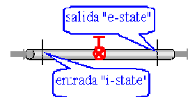
Fig. 1. Un estrangulador reduce la presión. El cambio en EC y EP no es alto.
